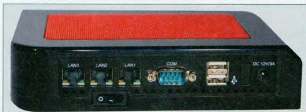
◀ Abbildung 1: An seiner Rückseite bietet der schwarze Zwerg Anschlüsse für DSL-Modem, LAN und DMZ sowie einen seriellen und zwei USB-Ports.
